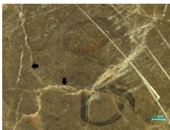
Figura 1. Fisuras rellenas por calcita
