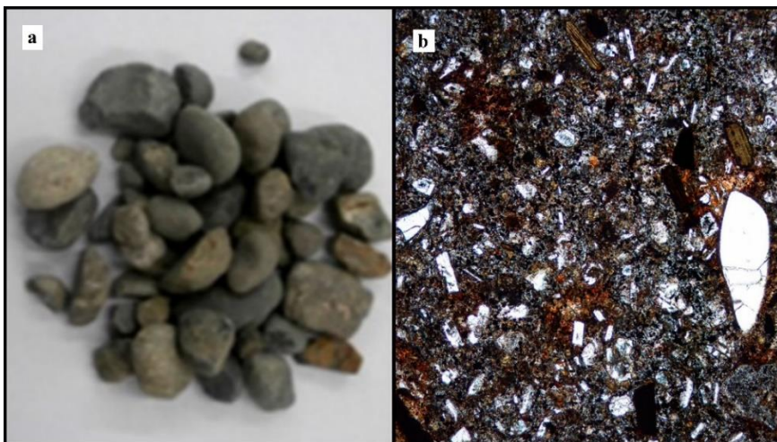
Figura 6. a) Áridos que componen la Calicata. b) Fotomicrografía de una andesita con textura porfídica, (fenocristales de plagioclasa, anfíbol, cuarzo y biotita con matriz formada esencialmente por vidrio).
