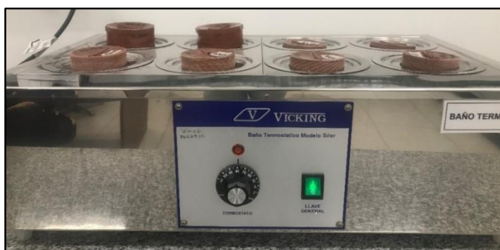
Figura 4. Muestras atacadas con NaOH en baño termostático.
