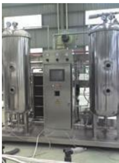
Imagen 11 Equipos de mezclado de azúcar y agua para obtener jarabe simple
